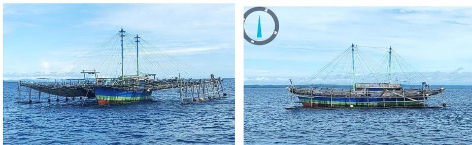
**Gambar 4. Bagan perahu (*Boat Lift Nets*)**
